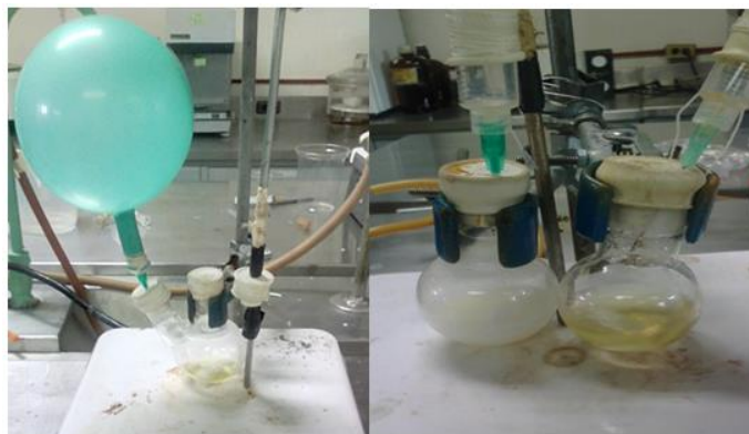
Figura 27: Síntesis de los copolímeros en atmosfera inerte
